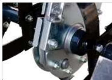
MET BOUTEN BEVESTIGDE MESSEN Met bouten bevestigde as in aluminium met beschermplaat
